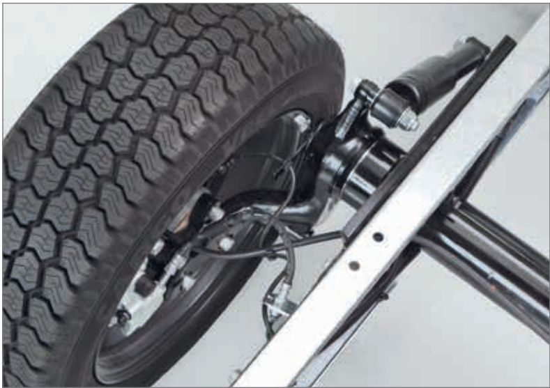
Einzelradaufhängung mit serienmäßiger Drehstabfederung
