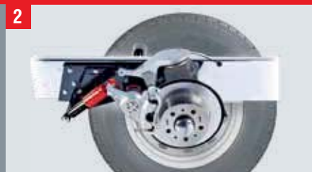
Manuell regelbare Luftfederung
