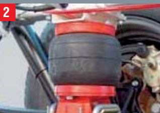
Einbausituation Air Top X244
