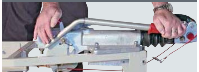
Handbremshebel angezogen = Bremsgestänge gespannt, Handbremshebel abgesenkt
