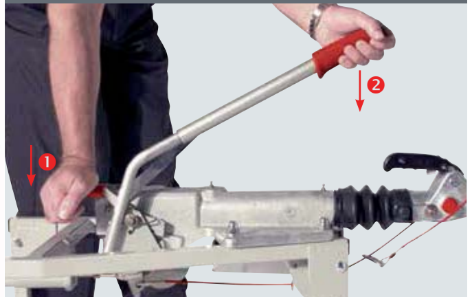
Handbremshebel angezogen = Bremsgestänge gespannt, Handbremshebel abgesenkt
