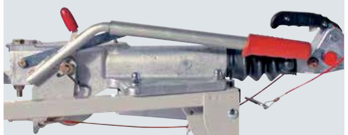
Handbremshebel angezogen = Bremsgestänge gespannt
