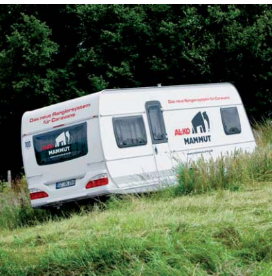
Steigfähigkeit je nach Bodenbeschaffenheit maximal 28 %
