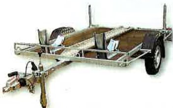
Motorrad-Anhänger Auflaufgebremst mit klappbaren/verstellbaren Bügel (Wippe) & Auffahrtsschienen
