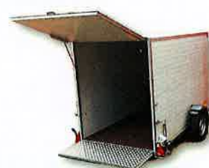
Koffernanhänger mit absenkbarer Achse, Bordwand Paneele geschäumt 30mm
