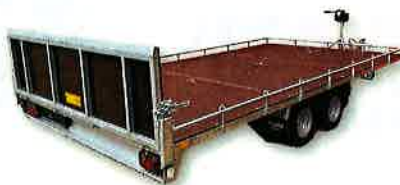
Baumaschinen-Transporter, Rampe mit Siebdruckplatte belegt und Seilwinde
