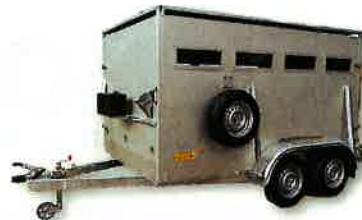
Viehtransport-Anhänger Alu-eloxiert mit Lüftungsschlitzen, Werkzeugkiste & Reserverad
