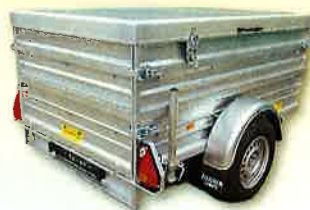
Tieflader Stahl-verzinkt mit Aufsatzwänden und Aludeckel
